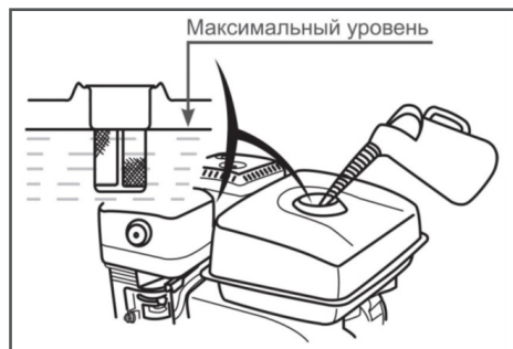
Рис. 10 Максимальный уровень топлива в топливном баке
