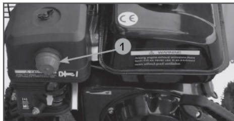
Рис. 16 Расположение ручного топливного насоса
