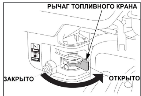
Рис. 13 Рычаг топливного крана
