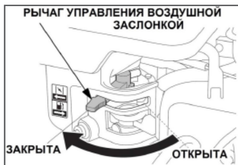
Рис. 12 Рычаг управления воздушной заслонкой
